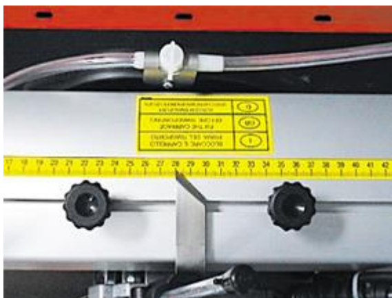
Рис. 5: Миллиметровая шкала на направляющей.
