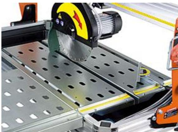
Рис. 6: Рабочий стол камнерезного станка PRIME.
