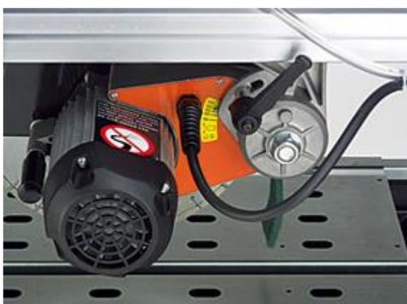
Рис. 4: Регулировка глубины реза камнерезного станка PRIME.
