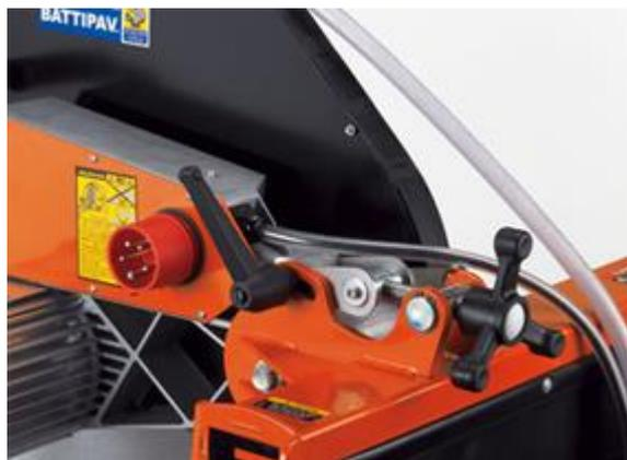
Рис. 9: Регулировка высоты режущего диска камнерезного станка EXPERT 700.
