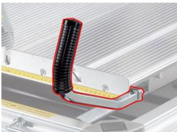
Рис. 2: Ручка на рабочем столе камнерезного станка EXPERT 500 / 600.
