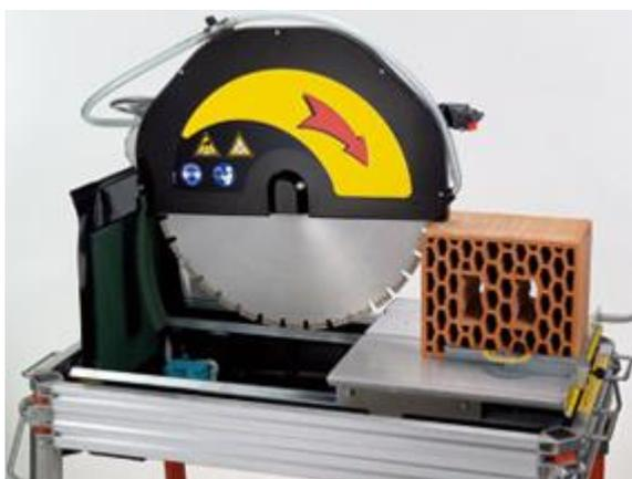
*Рис. 5: Прямой рез камнерезного станка EXPERT 500 / 600.*
